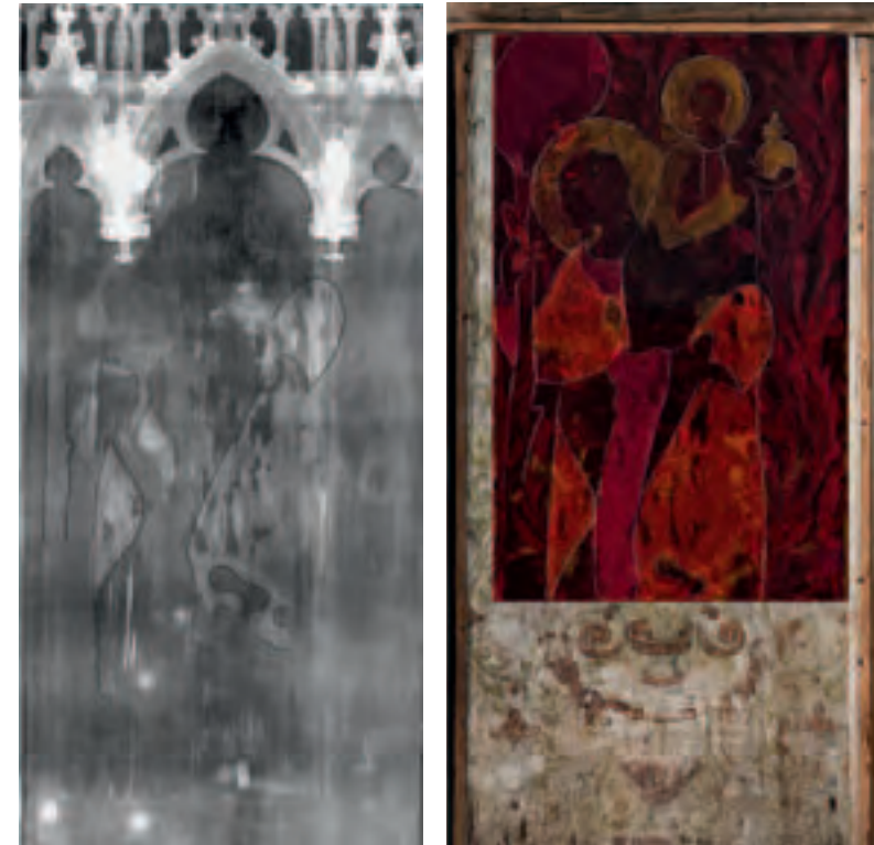
4 Mittelnischenrückwand des Altenberger Altarschreins, links: Röntgenaufnahme mit markiertem Baumstamm und Gewandfalten; rechts: Auflichtaufnahme der Übermalung von 1609 mit nachbearbeitetem Röntgenfluoreszenz-Mapping
